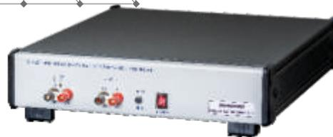
Преобразователь напряжение-ток Я9-44 обеспечивает преобразование постоянного и переменного напряжения (синусоидальной формы) до 30 В в силу тока до 30 А (соответственного постоянного и переменного) с коэффициентом преобразования 1 В / 1 А. При этом диапазоне входных напряжений 0,1 мВ – 30 В соответствует выходной ток 0,1 мА – 30 А.
