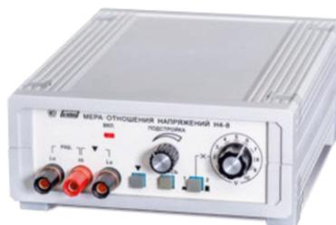
Мера отношения напряжений Н4-8 предназначена для определения линейности основных пределов вольтметров, аналого-цифровых преобразователей (АЦП), делителей и т.п., а также для расширения диапазона однозначных мер напряжения и Э.Д.С. Основу прибора составляет резистивная декада (десять последовательно соединенных равнономи-
