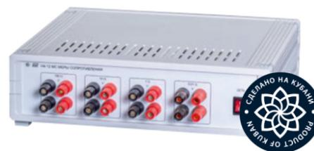
Меры сопротивления Н4-12МС с номинальными значениями сопротивлений 100, 10, 1 и 0,01 Ом изготовлены на основе прецизионных резисторов с низкой температурной зависимостью и очень малой частотной погрешностью. Технологические и конструктивные решения изготовления мер сопротивления обеспечивают сохранение частотных характеристик в течение всего срока эксплуатации.
